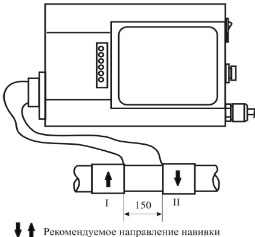
Рисунок 1 Условная схема монтажа прибора и проводов излучателей.
