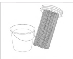
Достаем мембрану и в ручную убираем остатки грязи
